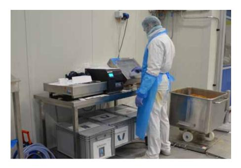
Die Waren werden nach jedem Produktionsschritt verwogen und aus dem ERP-System heraus Etiketten gedruckt, um den Inhalt genau zu kennzeichnen.
