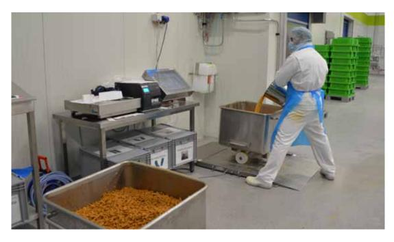
Die Marinade wird auf der Waage eingefüllt. Erst wenn die vorab errechnete Menge erreicht ist, kann der nächste Produktionsschritt im System gebucht werden.
